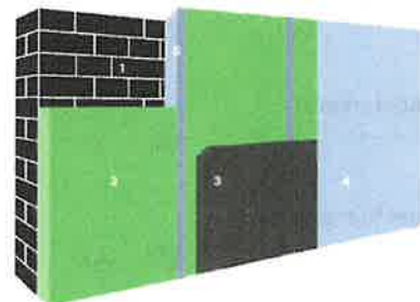
1. Buitengevel | 2. Isolatie | 3. Dampschermb | 4. Binnenafwerking | 5. Stijl- en regelwerk (optioneel)
